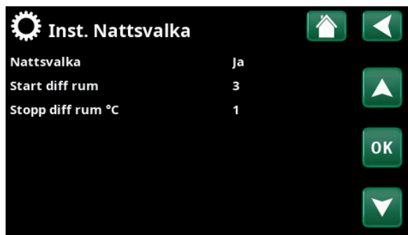
Meny "Avancerat/Inställningar/Inst. Ventilation/Inst. Nattsvalka".
